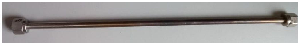
Ilustración 5: Reactor tubular de un cuarto de pulgada
