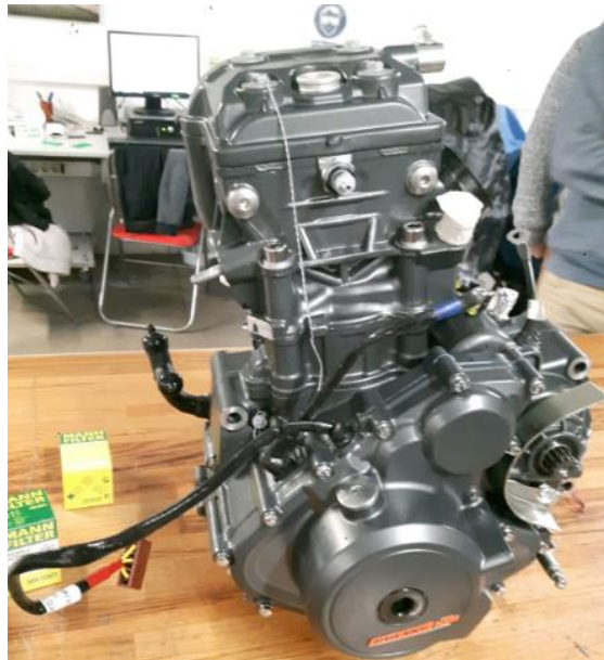
Ilustración 5: Motor KTM RC 250 recibido por el equipo
