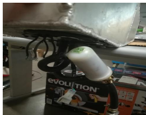
Ilustración 56: Bomba colocada en el depósito
