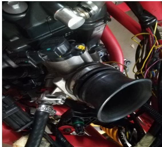
Ilustración 54: Garganta de mariposa colocada en el conducto de admisión
