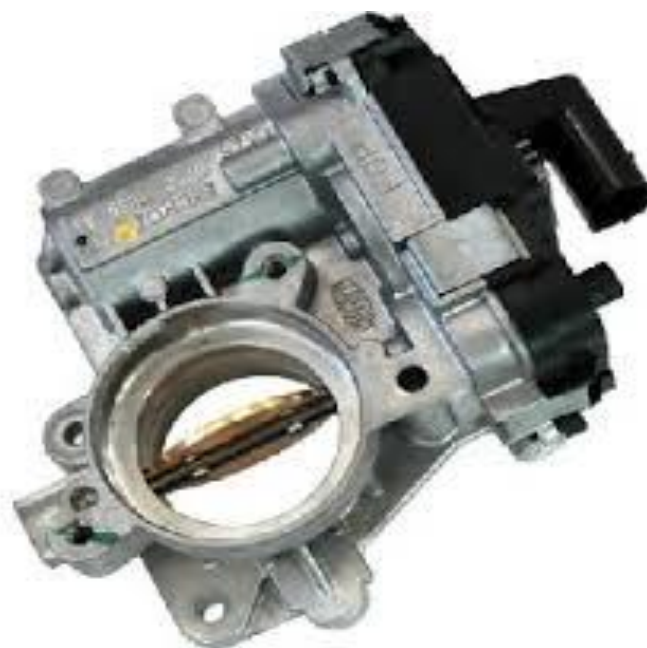
Ilustración 47: Válvula de mariposa abierta a más del 95%
