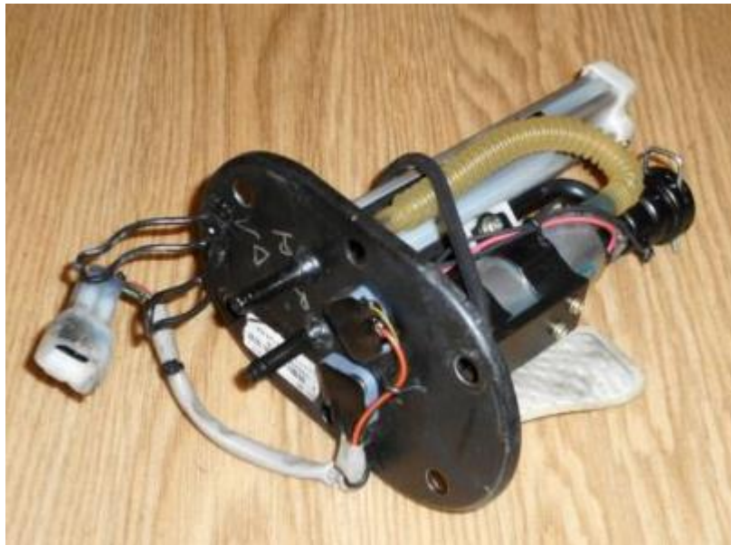
Ilustración 24: Bomba de combustible empleada
