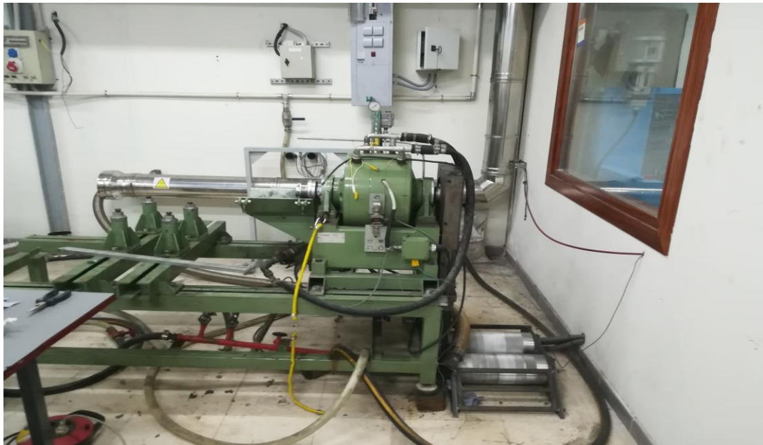
Ilustración 41: Banco de pruebas. Freno y rodillo
