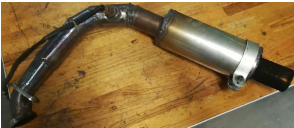
Ilustración 22: Sonda Lambda introducida en el escape
