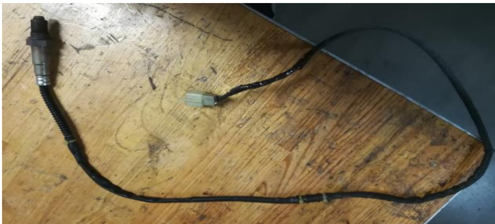
Ilustración 21: Sonda Lambda empleada.
