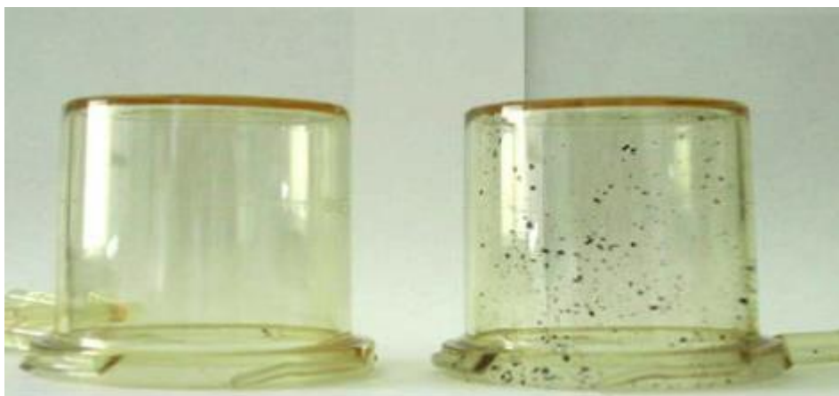
Figura 2.5.16. Puntos negros apreciables en pieza transparente.
