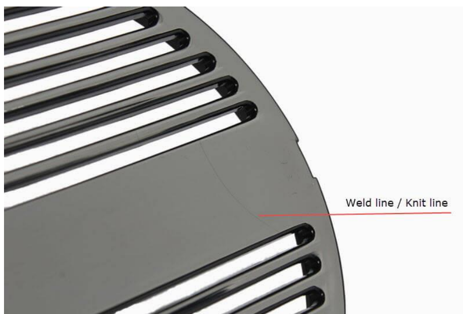
Figura 2.5.9. Líneas de soldadura.
