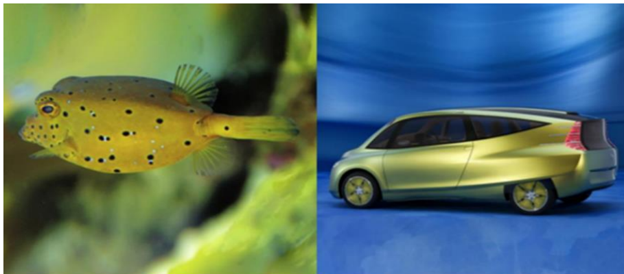
2.3. Irudia. Ezkerrean ostraciidae izeneko arraina eta eskuinean Mercedes-Benz enpresaren autoa ostrazido arrainaren itxuraren imitazioarekin. (Rodríguez et al. 2013)
