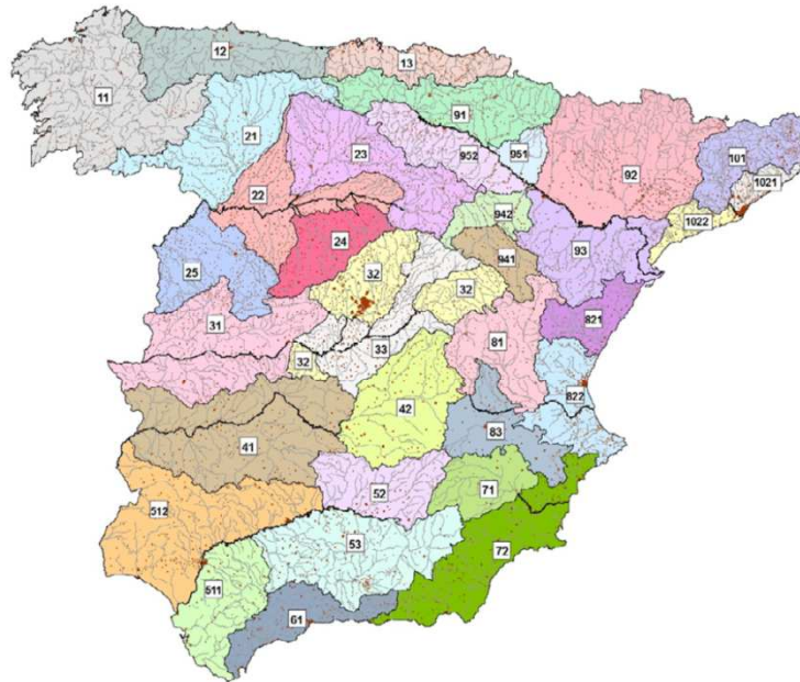
Fig. 5 Regiones consideradas para la caracterización del coeficiente corrector del umbral de escorrentía. Fuente: Norma 5.2-IC Drenaje superficial
