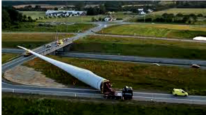
Figura 30: Transporte de las palas (Apuntes Egela)
