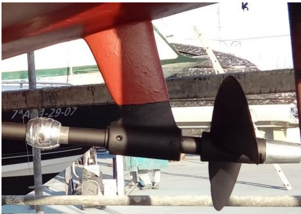
Ilustración 15: Ánodos de sacrificio nuevos.
