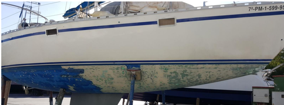
Ilustración 5: Decapando las capas de pintura.
