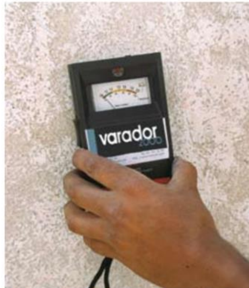
La aguja en la zona roja del medidor refleja un alto grado de humedad. En la segunda foto –tomada meses después- la aguja ya está en la zona verde
