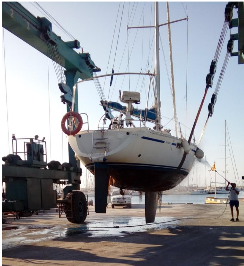
Ilustración 3: Limpieza a presión del casco.
