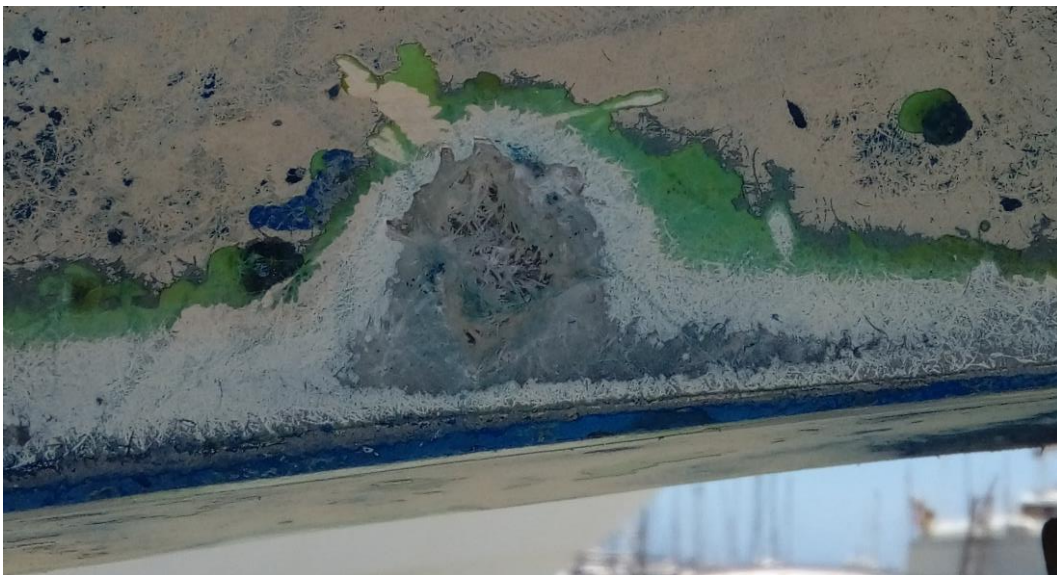
Ilustración 11: Zona con principio de ósmosis.
