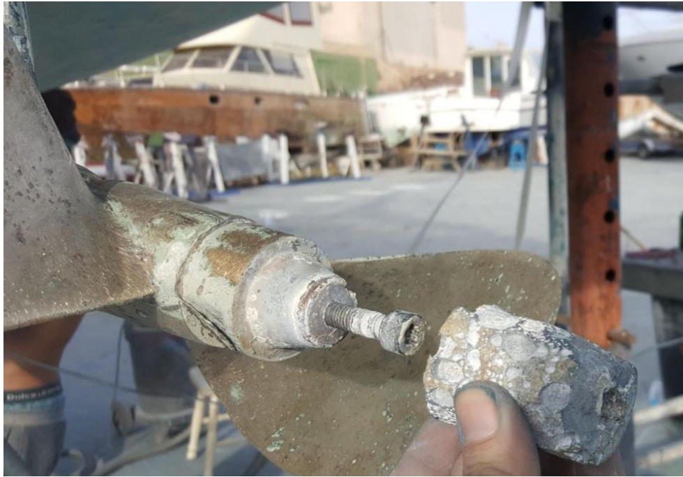
Ilustración 14: Ánodo de sacrificio desgastado.
