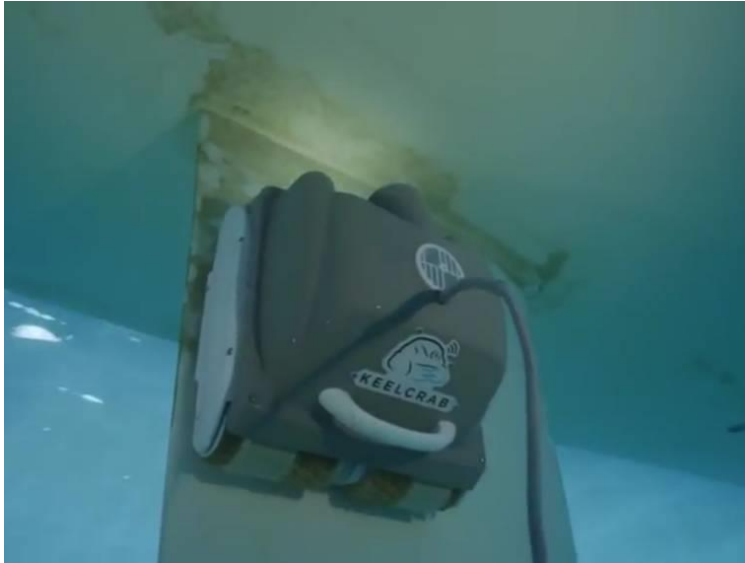
Ilustración 29: Robot limpiando en una superficie vertical.
