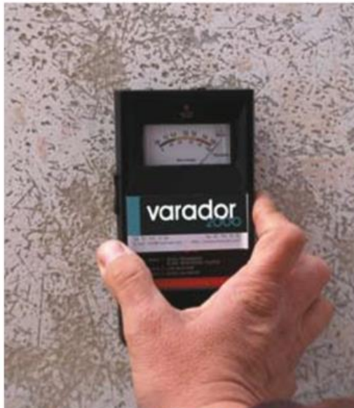
La aguja en la zona roja del medidor refleja un alto grado de humedad. En la segunda foto –tomada meses después- la aguja ya está en la zona verde
