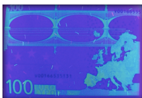
Figura 41. Ejemplo de tinta fluorescente vista con luz ultravioleta. Elaboración propia.
