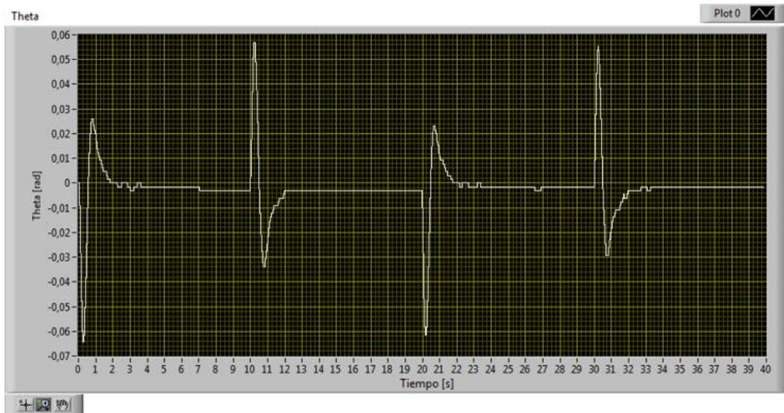
Figura 69. Ángulo del péndulo Gantry en la prueba
