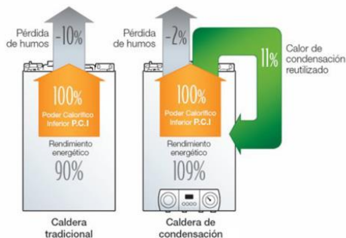
Figura 25. Comparación rendimientos caldera tradicional vs. caldera condensación.
