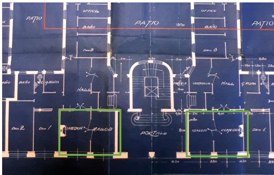
9. Irudia: Manuel María Smithek Gran Via 43rako egindako plano. Bi apartamentuetako kasuan agerian non saloia eta jangela elkartutik agertzen diren. BFAH/ AHFB. BILBAO FOMENTO 0255/155.
