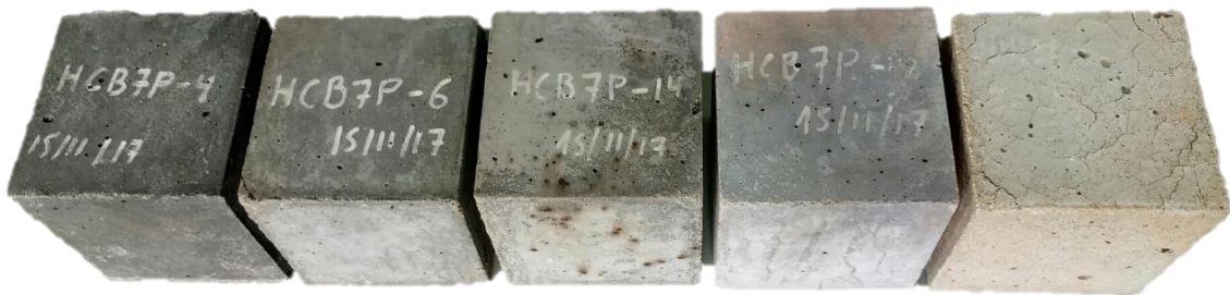
Figura 5. Estado de las probetas tras la aplicación de los gradientes térmicos (100-300-500-700-1000 °C).
