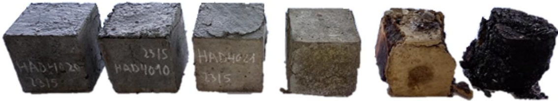
Figura 1. Probetas sometidas a gradientes térmicos y al ensayo de resistencia a compresión (100-300-500-700-1000-1200°C).
