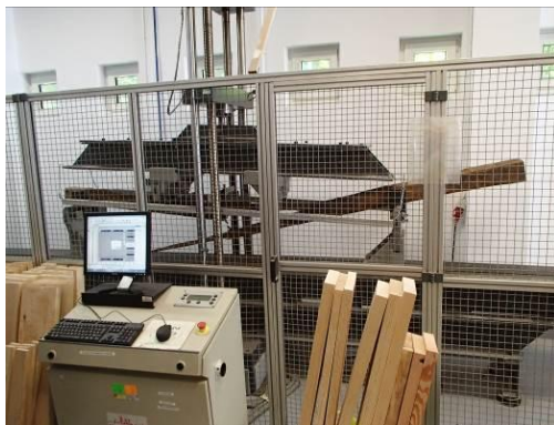
Figuras 23 y 24. Rotura de solivo (izquierda) y captura de pantalla (derecha) donde se representan todas las gráficas de los ensayos del primer lote de madera.
