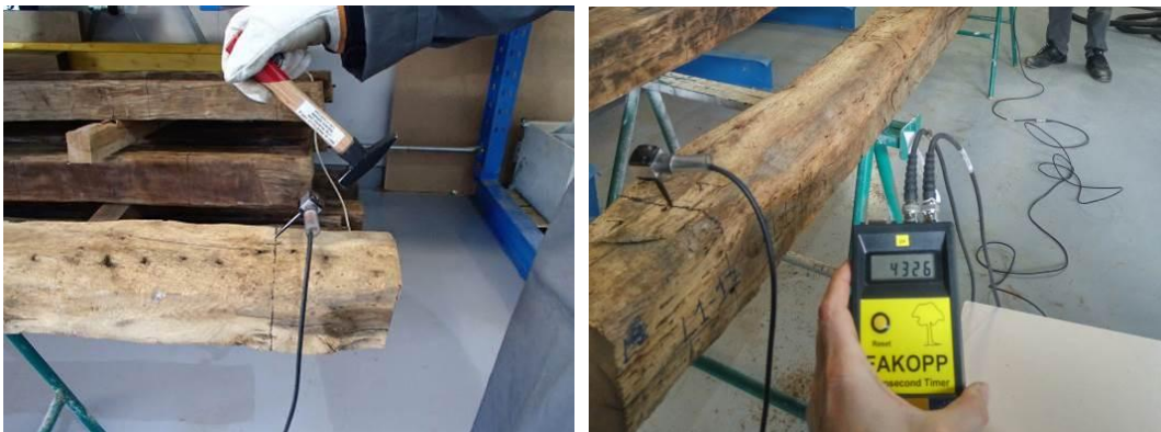
Figuras 19 y 20. Ensayos de ondas de impacto.
