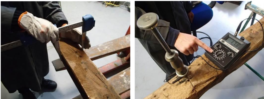
Figuras 17 y 18. Toma de datos básicos de geometría y humedad de los elementos
