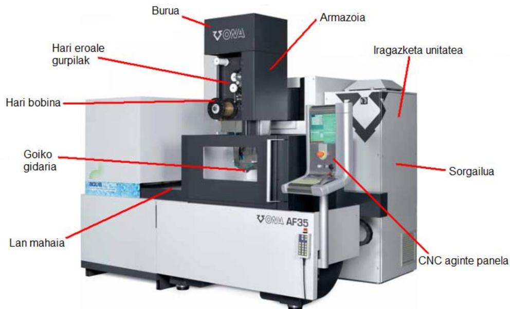
Irudia 56.- Haril bidezko elektro erosio makinaren parteak.
