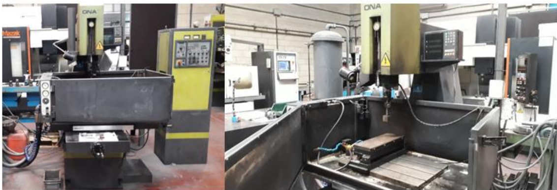
Irudia 62.- Enpresako ONA IC-275 barneratze bidezko elektro erosio makina.
