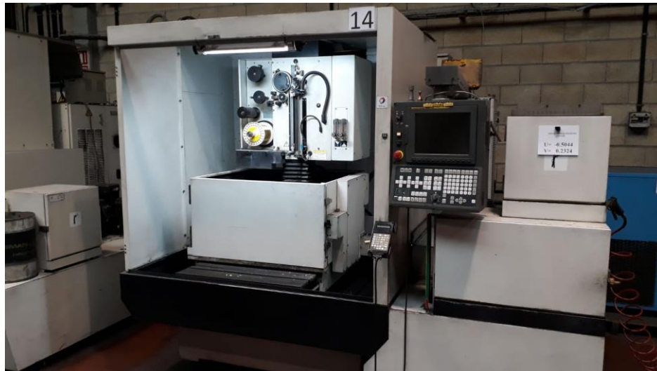
Irudia 61.- Enpresako FANUC 310is-WA haril bidezko elektro erosio makina.
