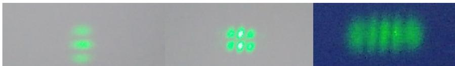
Figura 3.19: Modos de Hermite-Gauss 02, 21 y 30
