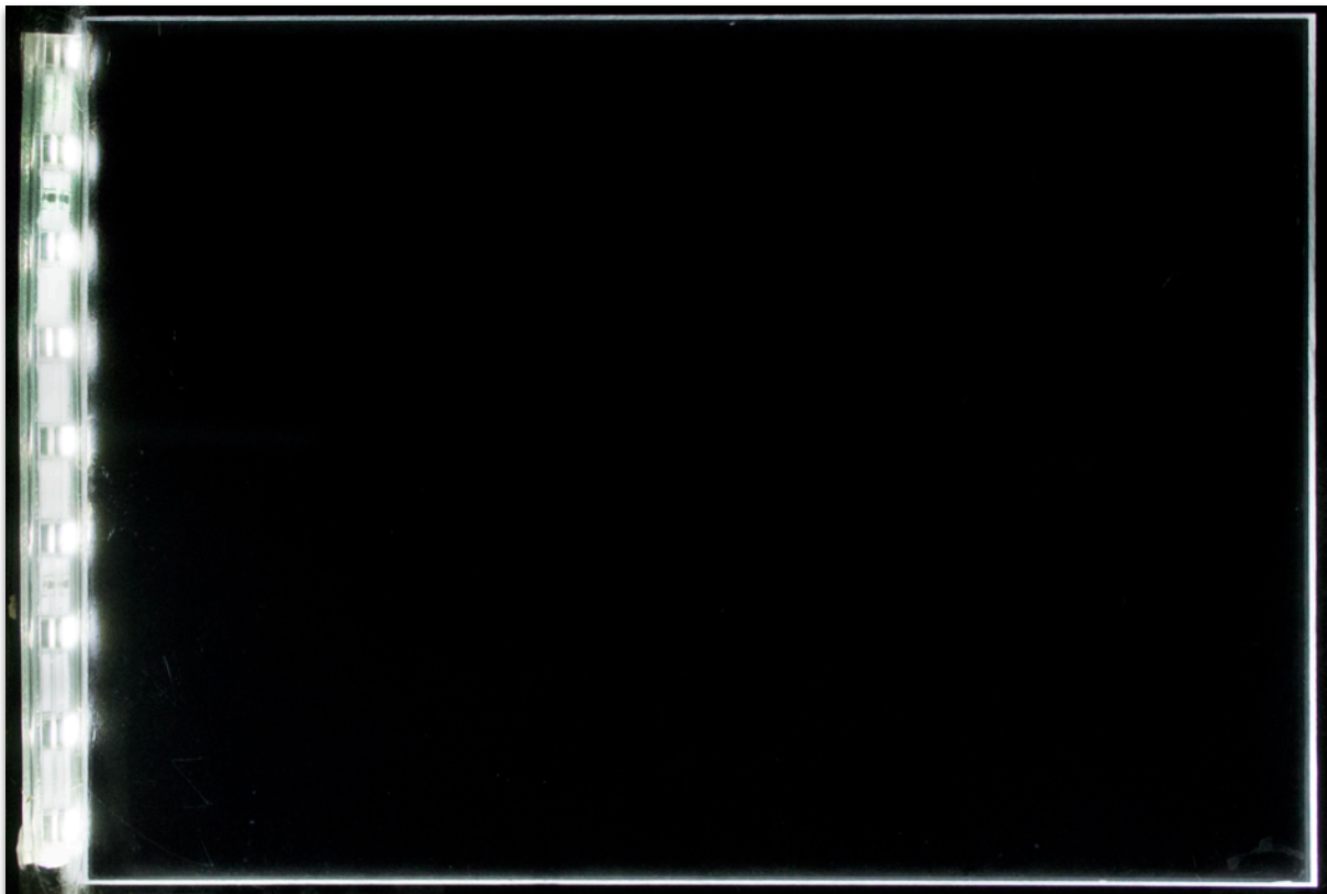
Imagen 1: LGP acoplada a tira de LEDs.
