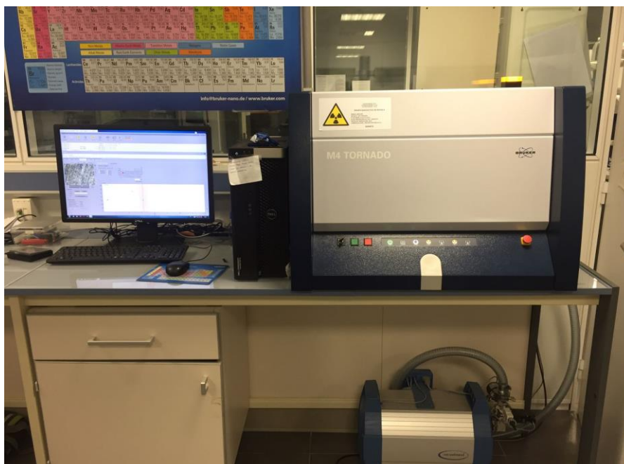
Figura 7. Imagen del equipo de fluorescencia de Rayos X utilizado para el análisis elemental de los clavos. Fuente: Elaboración propia.
