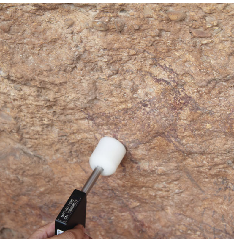
Figura 94. Detalle de la utilización de la sonda del espectroscopio Raman en una figura del Abrigo Grande de Minateda © J. F. Ruiz
