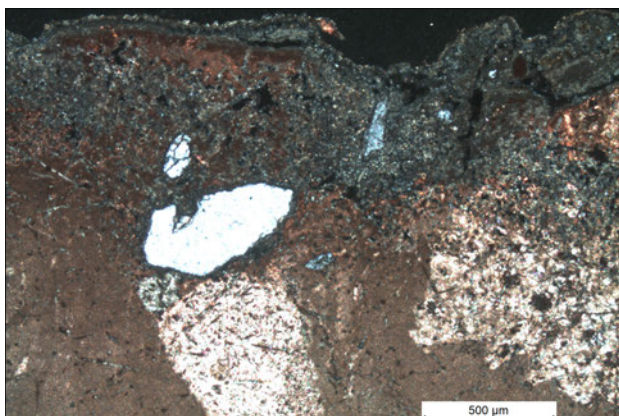
Figura 390. Microfotografía de la muestra BA003 en sección teñida con alizarina donde se aprecia la textura general del soporte y el carácter heterogéneo de la costra (NC – 5x)
