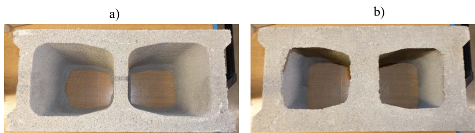
Figura 67 Forma de los huecos en la parte a) superior e b) inferior de los bloques.
