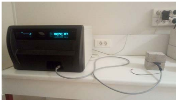
Figura 49 Dispositivo de disco caliente y probeta ensayada.
