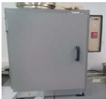
Figura 46 Acondicionamiento de las probetas en el horno.
