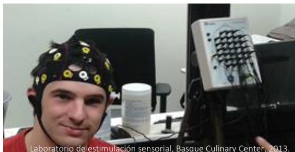
Imagen 1. Colocación de electrodos y equipo de captura de señal eléctrica neuronal.
