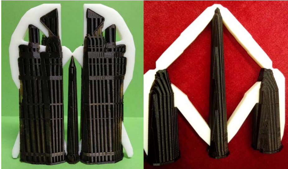
Irudia 6.17. Gripper eta inbertsore mekanismoen diseinu ez murriztuen prototipo inprimatuak.
