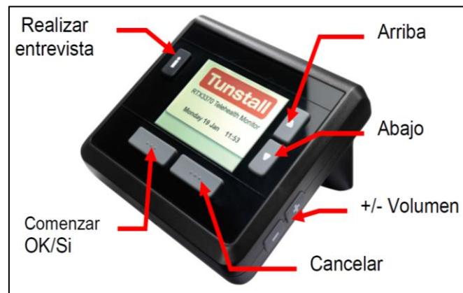
Figura 5. MyMedic, base receptora para la transmisión de los parámetros.
