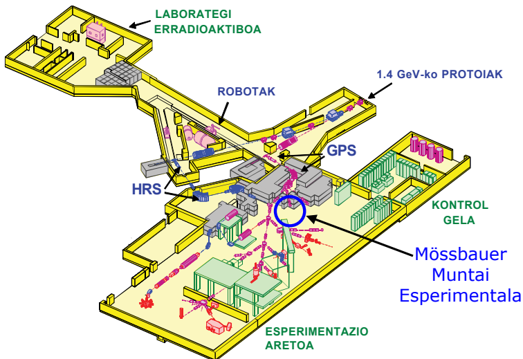
2.19 Irudia: ISOLDE instalazioaren banaketa-eskema 1.4 GeV-ko energiadun protoiak ioi erradiaktiboak lortzen diren itu batera bideratzen dira.
