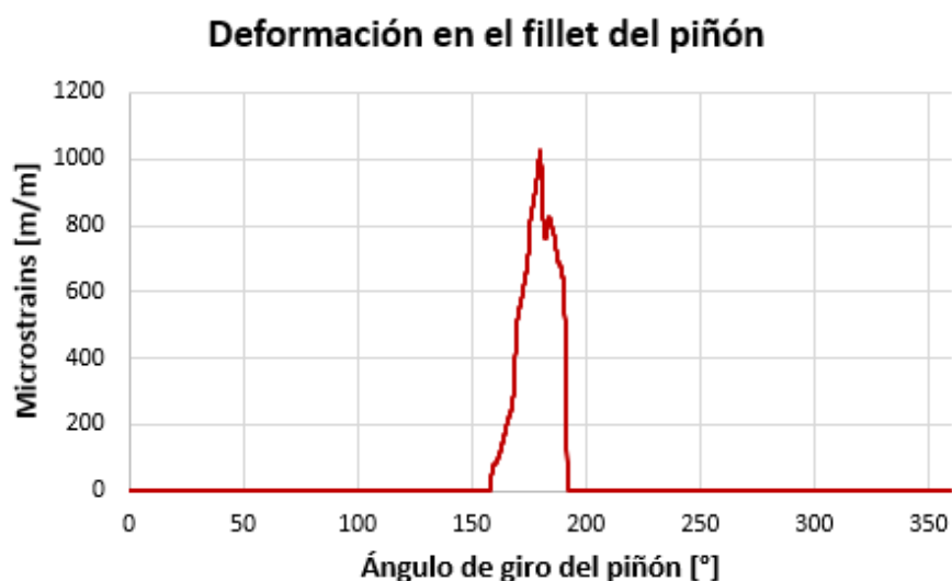
Gráfica 8.13: Deformación en el fillet del piñón a 183 N·m y 20 rpm en el ensayo experimental
