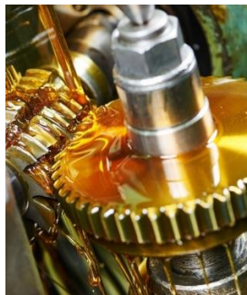
Figura 5.26: Generación de engranaje por fresado con hob [Dilube Chemical Specialities]
