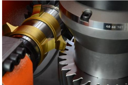
Figura 5.27: Generación de engranaje con piñón cortador [Industry Arena]
