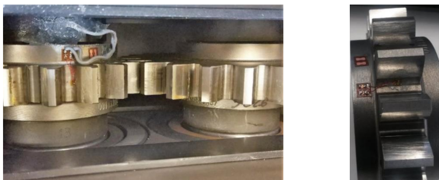
Figura 8.30: Zona de posicionamiento de galga en ensayo experimental
