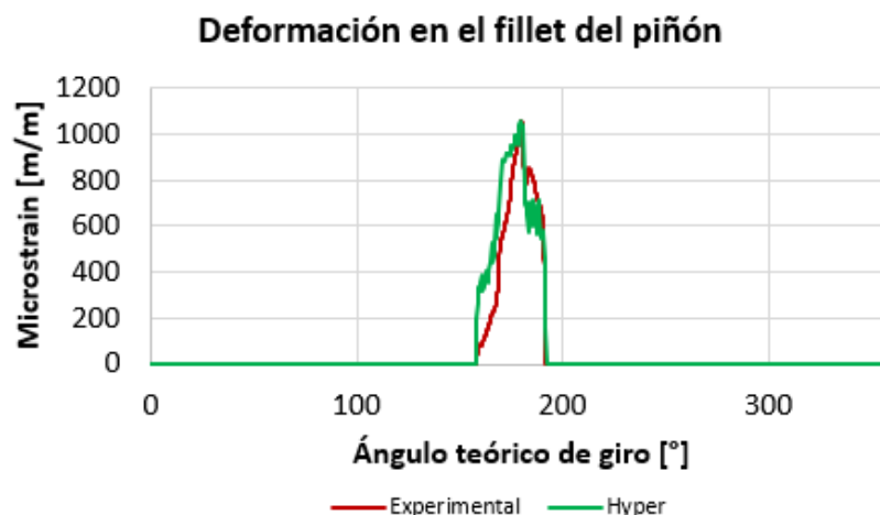
Gráfica 9.4: Comparación deformación entre Hyper y experimental (360 grados)
