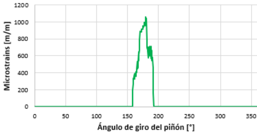
Gráfica 8.5: Deformación en el fillet del piñón en Hyper
