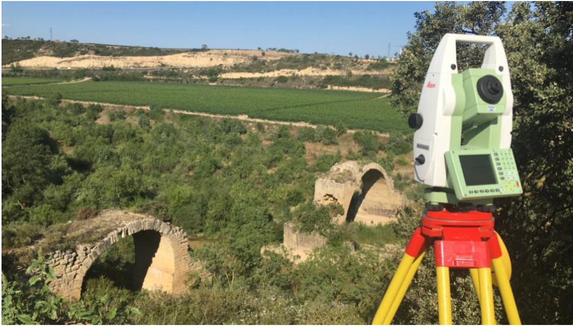
Fig. 9.- Medida de puntos destacados en el arco de la margen derecha (a la izquierda de la imagen) con estación total desde el borde del camino de acceso.
