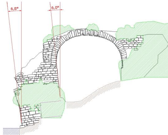
Fig. 35.- Inclinación del pilar junto al río del arco derecho, medida sobre el alzado aguas arriba.
