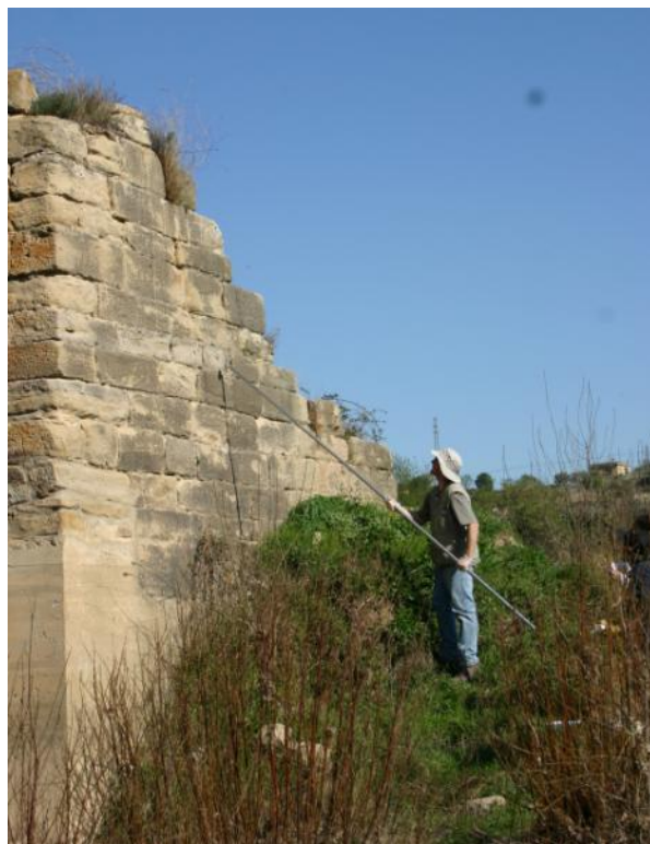
Fig. 8.- Colocación de una diana de 4x4 cm a unos 4 metros de altura utilizando un jalón adaptado.
