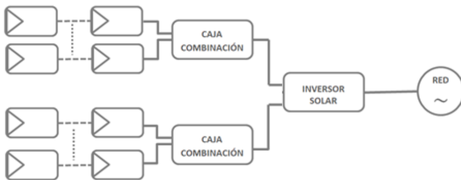
Ilustración 9 Diagrama de un sistema fotovoltaico conectado a red [Fuente: Propia]
