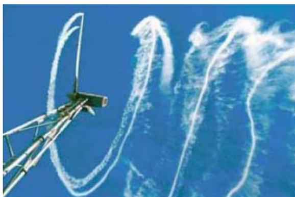
**Figura 34. Efecto de la estela de una turbina.**
