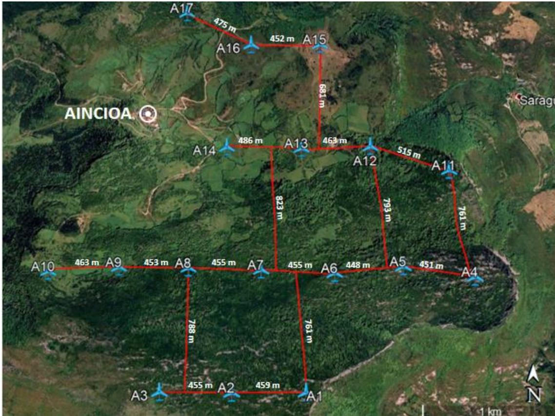
**Figura 37. Emplazamiento de cada uno de los aerogeneradores y las distancias entre ellos.**
