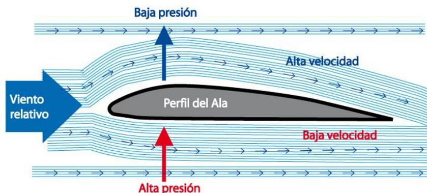
Ilustración 1. Fenómeno de sustentación en un perfil aerodinámico. [2]
