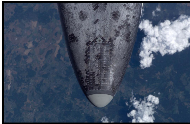
Imagen 8: escudo térmico cerámico de un transbordador espacial.
