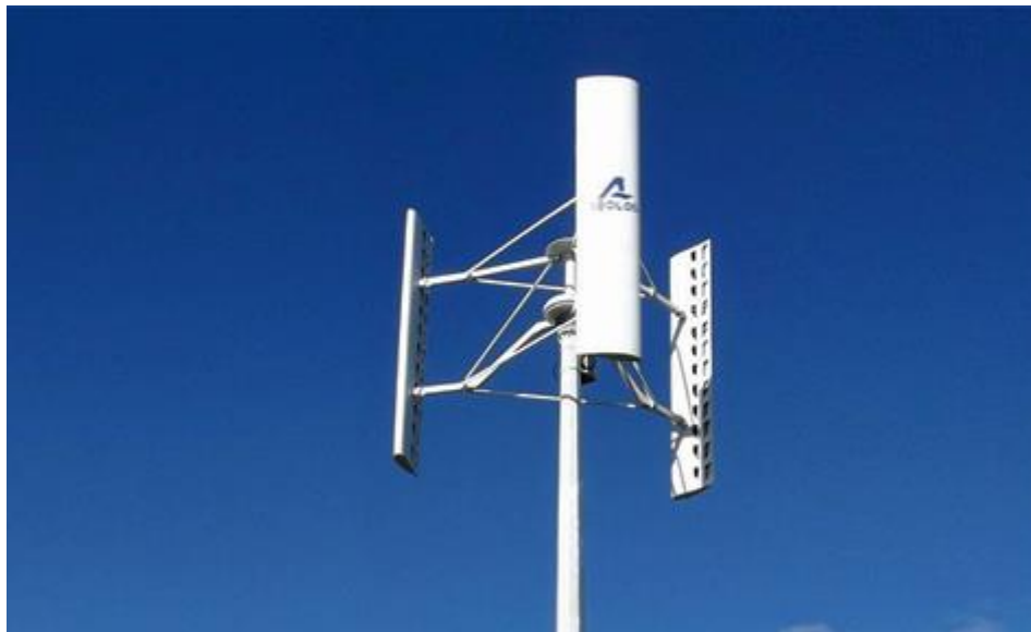
Ilustración 13. Aerogenerador Aeolos, modelo de eje vertical.
