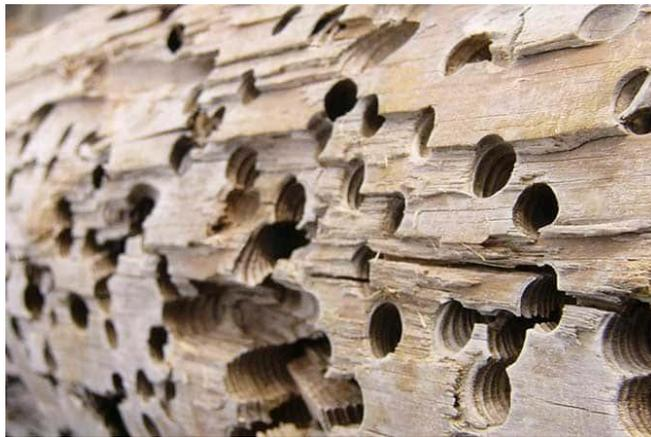
*Ilustración 20. Deterioro de la madera como consecuencia de la aparición de carcoma.
