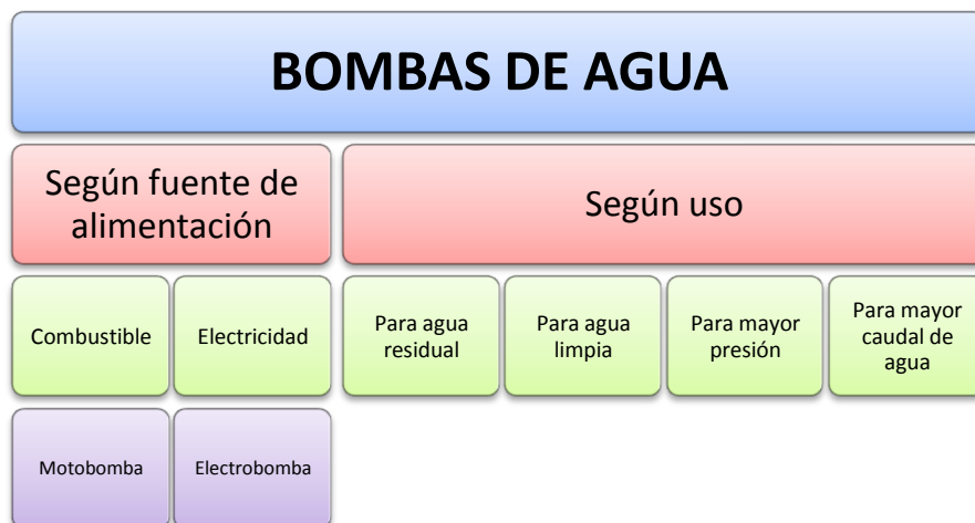
Ilustración 12: Esquema clasificación de las bombas de agua. Fuente: www.demaquinasyherramientas.com
