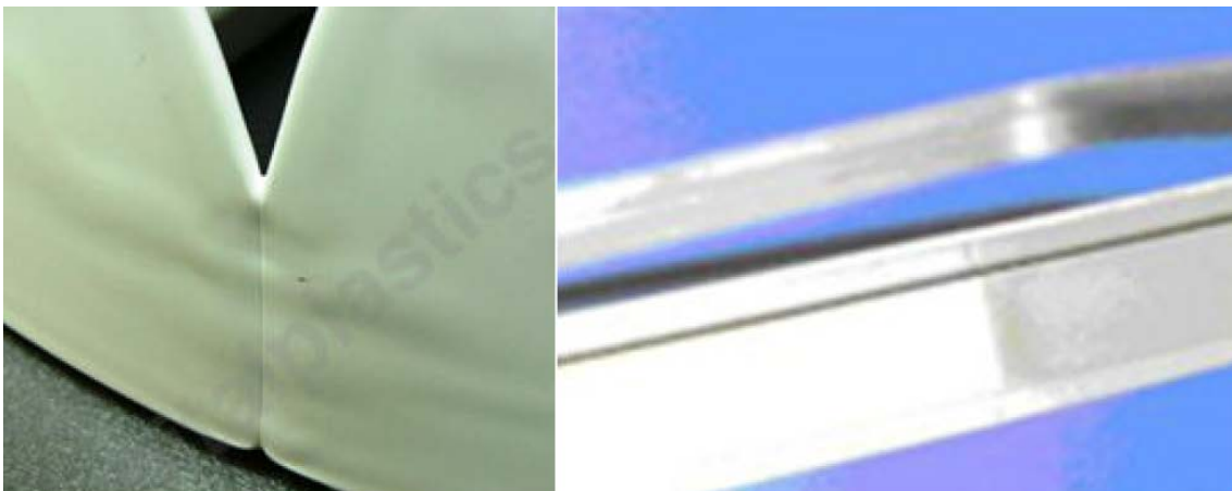
Imagen 32. Líneas de flujo o de soldadura.
