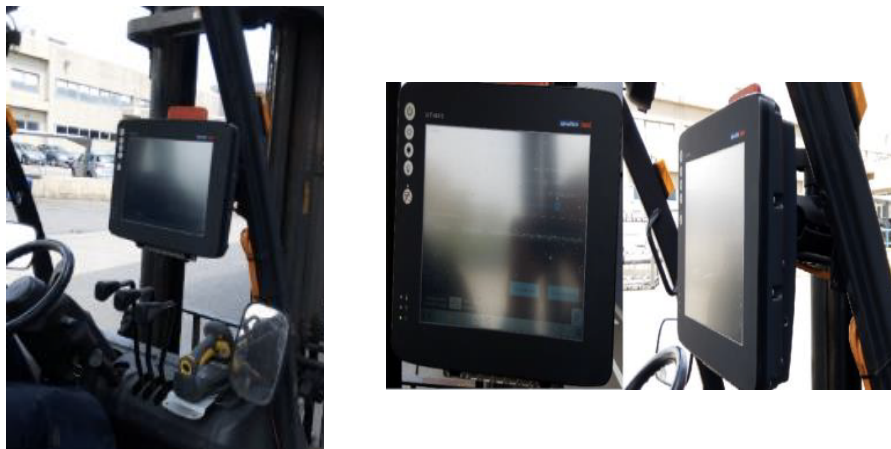
Ilustración 15. Pantallas táctiles en carretilla para aviso digital
