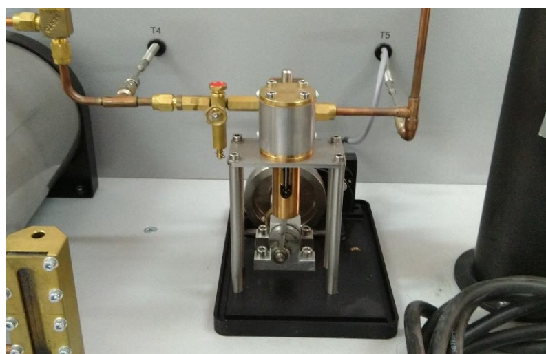
Figura 4. Pistón para la generación de energía de la caldera
