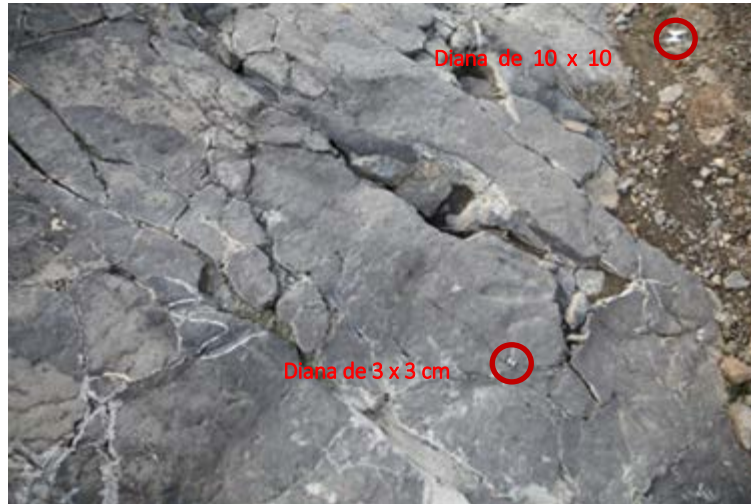
Fig.4. Señalización mediante dianas para la orientación de los modelos fotogramétricos de la Era del Peladillo.
