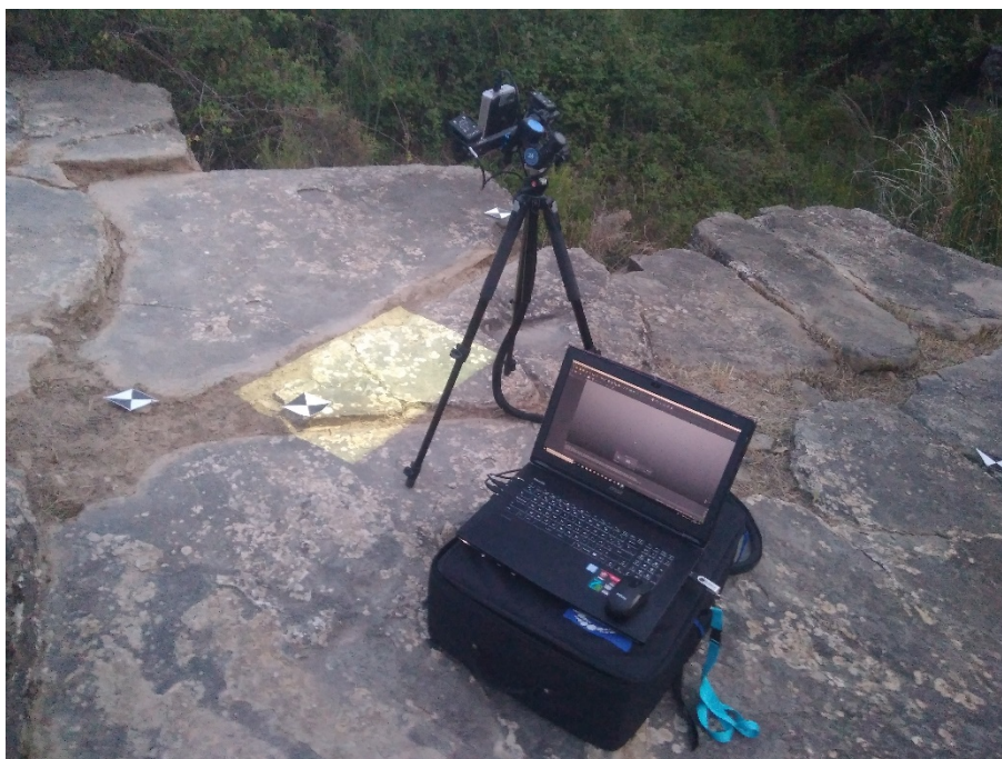
Fig.10. Imagen del escáner de luz estructurada, Scan in a Box , preparado sobre el terreno para el proceso de escaneo.
