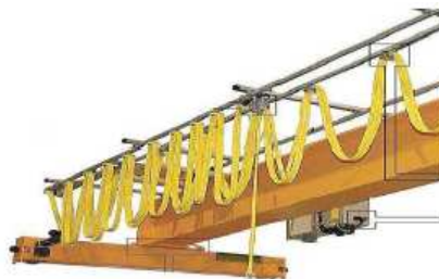
7.irudia: Elektrizitate hornidura linea
