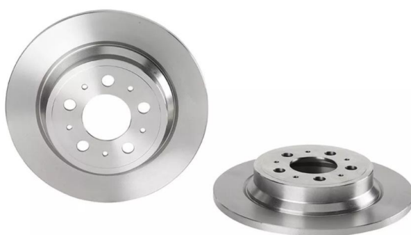
4. irudia. Balazta disko zurruna (Brembo Volvo S60 01-08).
