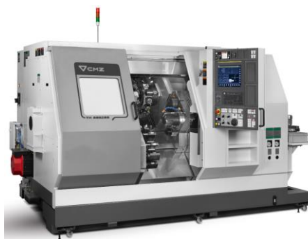
13. irudia. ZK tornua (Torno CNC TX66 Y3).
