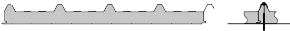
3.2.Irudia: Teilatuko panelen profila eta lotura
