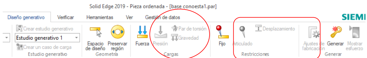
Figura 34. Barra de herramientas en la versión académica. Se observa la limitación a la hora de definir las restricciones de la pieza
