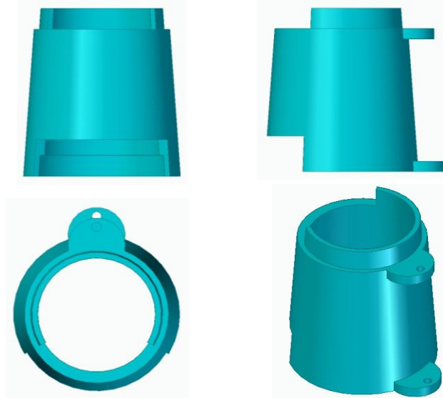
Figura 28. Alzado, perfil planta y figura del fragmento intermedio del tronco cónico.
