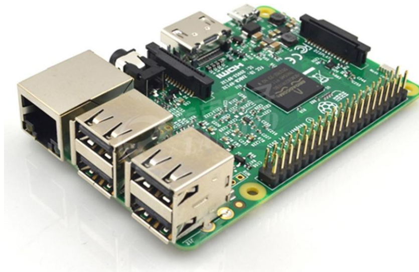
Figura 1 Tarjeta Raspberry Pi usada en el prototipo de fotogrametría.
