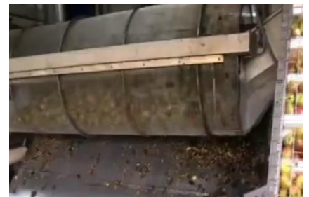
6. Irudia. Sagarraren garbiketa danborrean (Iturria: Bereziartu Sagardoak)
