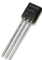
Figura 11. Sensor de temperatura LM35 en formato encapsulado TO92.
