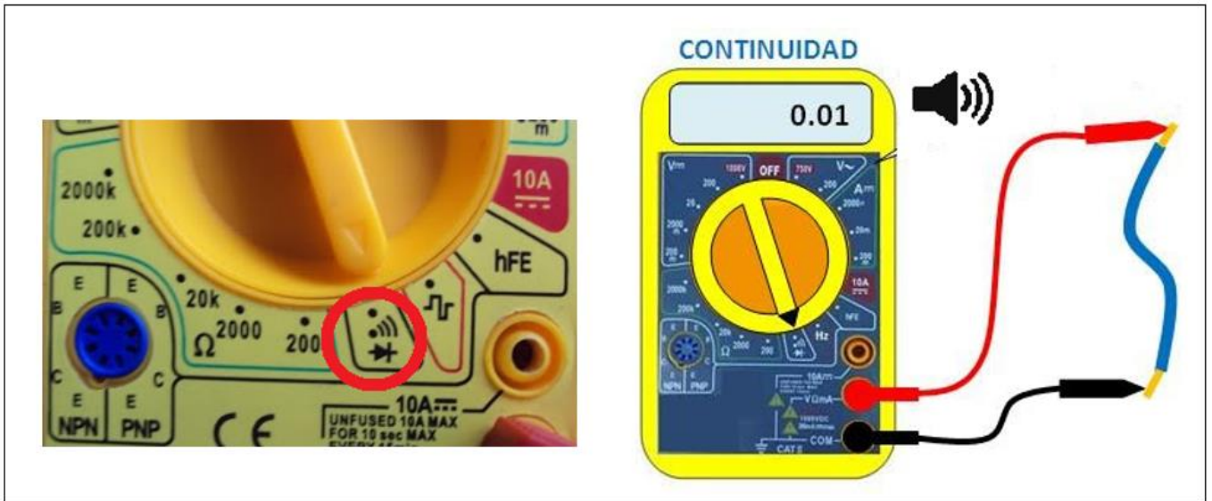
Figura 48. Modo continuidad multímetro para verificación de pistas de la PCB.
