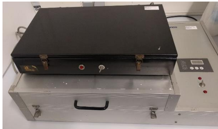
Figura 39. Insoladora, en el laboratorio de la Escuela de Ingeniería de Bilbao.
