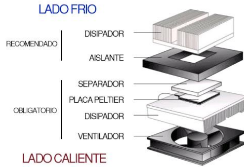
Figura 4. Montaje óptimo de una placa Peltier.
