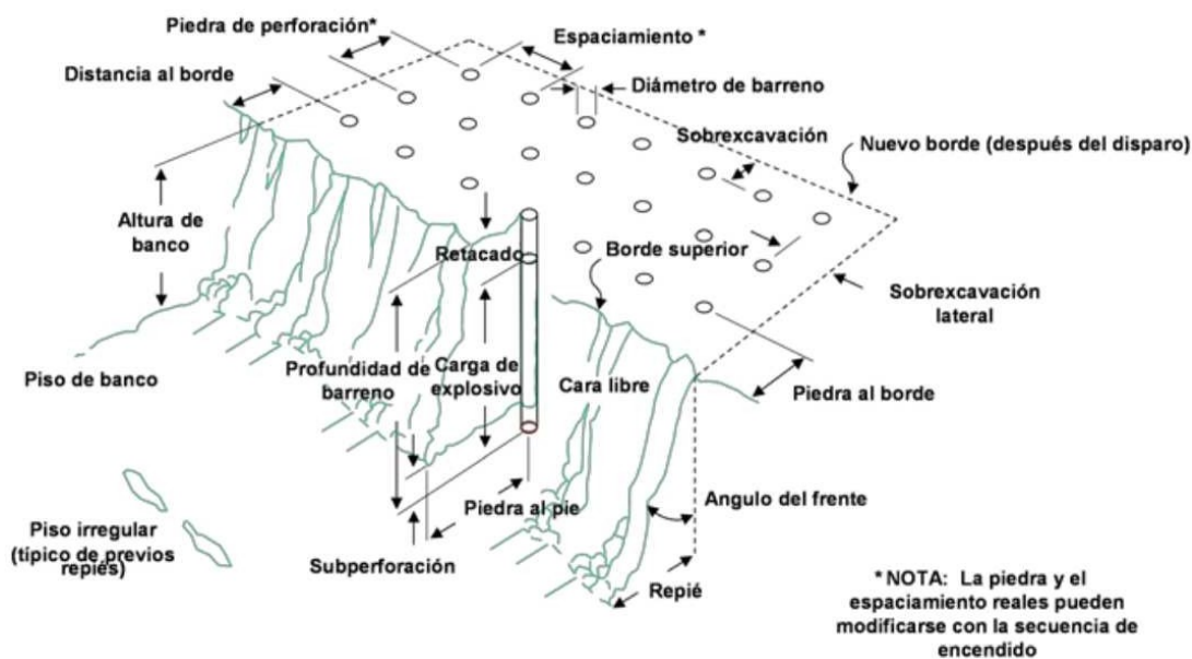
Ilustración 63. Parámetros voladura en banco.
