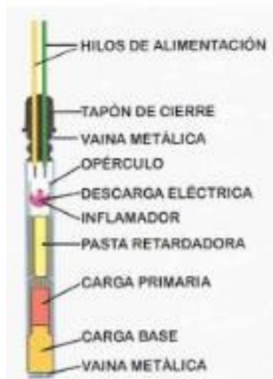
Ilustración 67. Partes detonador eléctrico.
