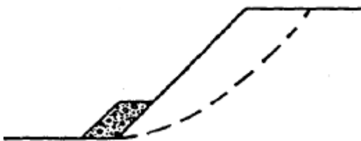
Deslizamiento por el pie.
