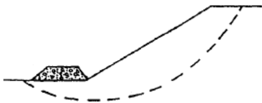
Deslizamiento por la base.
