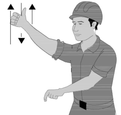
10 BAJAR EL AGUILON O PLUMA Y LEVANTAR LA CARGA
