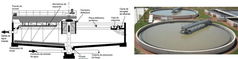
Figura 10 Sedimentador circular. [21]
