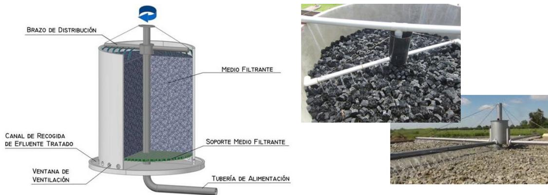
Figura 13 Partes del lecho bacteriano y tipos de soportes [31]
