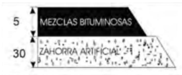
Figura 42 Sección de explanada escogida. [54]
