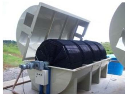
Figura 14 Sistema completo de depuración de aguas residuales mediante discos biológicos. [33]
