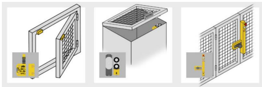
ILUSTRACIÓN 9. RESGUARDOS MÓVILES CON VARIOS TIPOS DE INTERRUPTORES DE ENCLAVAMIENTO (PILZ)
