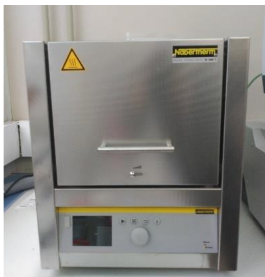
Figura 7.2.- Horno de sinterizado Naverterm 1500 utilizado en los tratamientos de sinterizado de las muestras.
