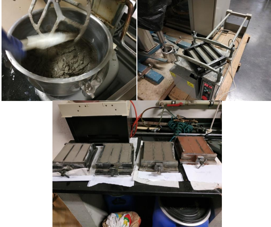
Figura 21 Amasado, compactado y resultado final de las probetas.
