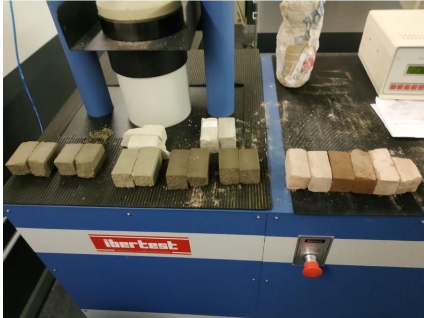
Figura 24. Morteros tras el ensayo de flexotracción, se puede observar la cantidad de polvo desprendido por cada uno de ellos debido a su fragilidad.
