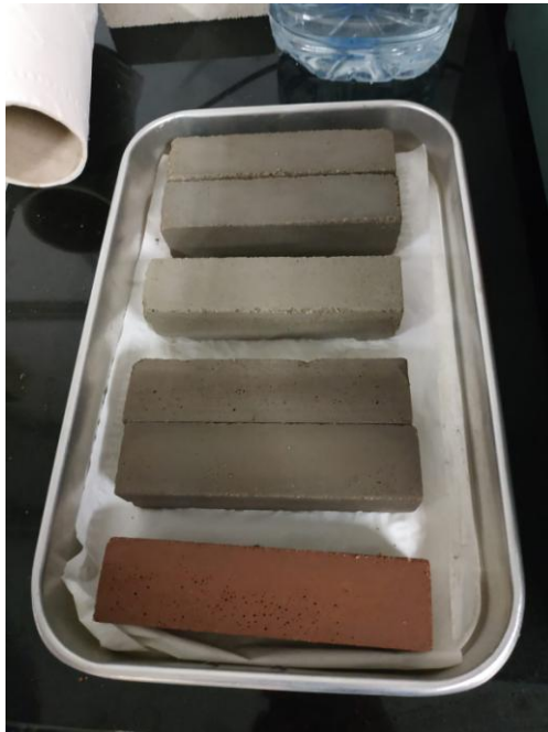
Figura 23 Probetas endurecidas en agua durante 28 días
