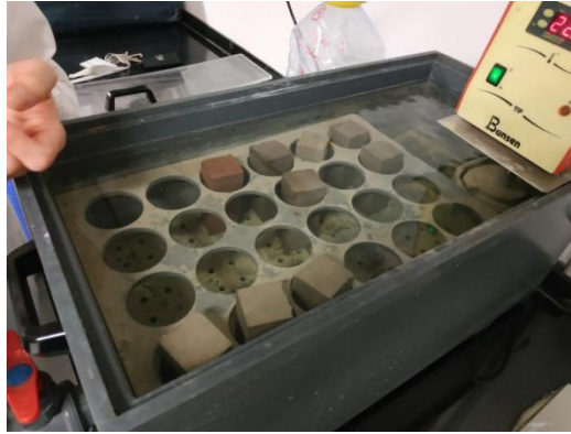
Figura 22 Curado de las probetas en agua durante 28 días (izquierda)
