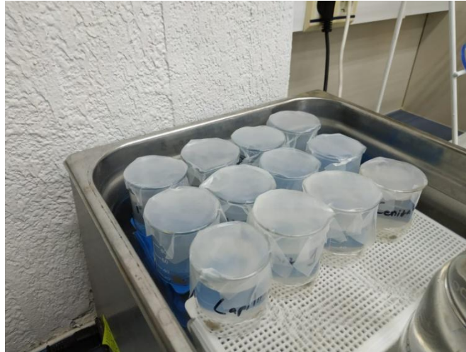
Figura 7 Extracción de sales solubles en ultrasonidos.
