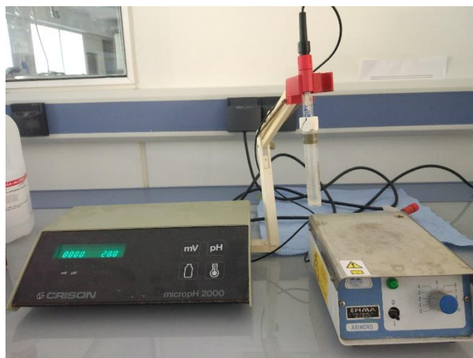
Imagen 9. MicropH-metro 2000 de la marca Crison, con el electrodo 52-02 de medida del pH acoplado en el brazo móvil del instrumento.
